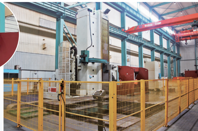
意大利PAMA加工中心 Italian PAMA boring and milling machine
